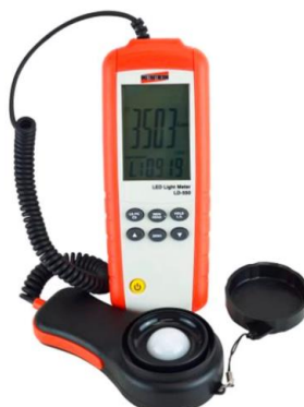
Figura 16 - Luxímetro ICEL LD-550 utilizado em campo.
